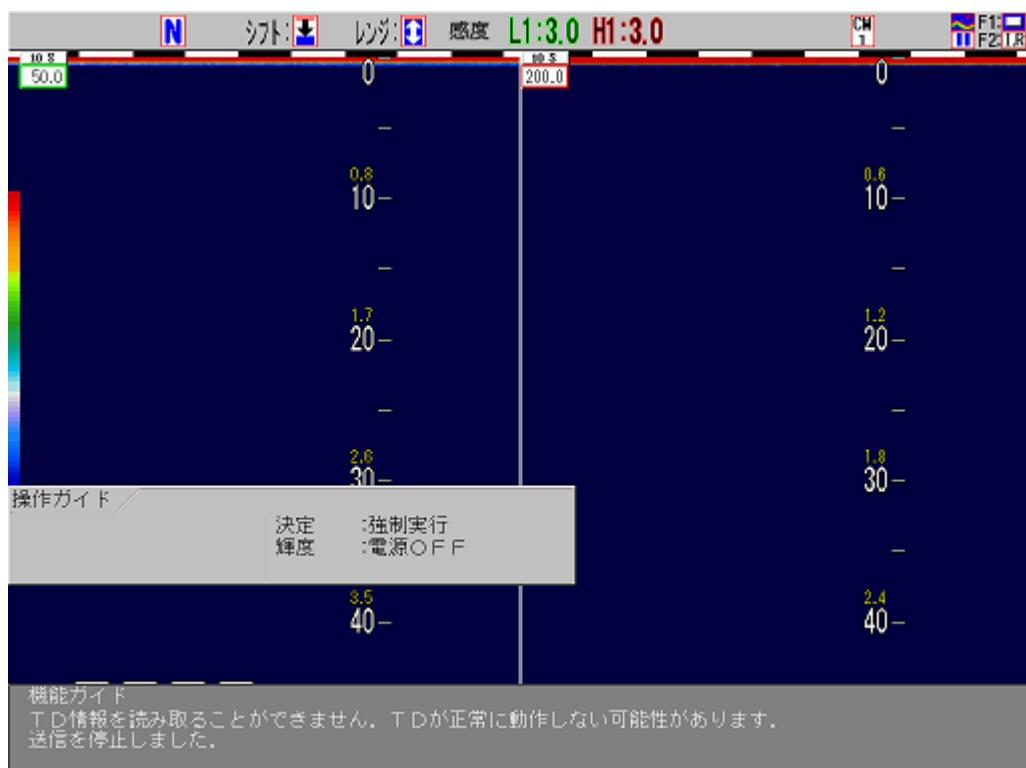
【輝度○】キー を長押して、電源をOFFしてから送受波器の結線を確認してください。
